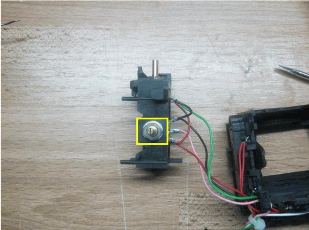
Als nächstes drehen wir die Achse des Poties der langen Seite so weit, das der Schlitz parallel zum Rahmen in Längsrichtung verläuft. Ob man die Mitte hat, nochmal durch Rechts- und Linksdrehen kontrollieren. Jetzt wird der Knüppelgriff wieder auf die Potiachse aufgeschoben. Auf der gegenüber liegenden Seite muss der kleine Zapfen ( eventuell einfetten ) in ein Loch im Rahmen gesteckt werden.
