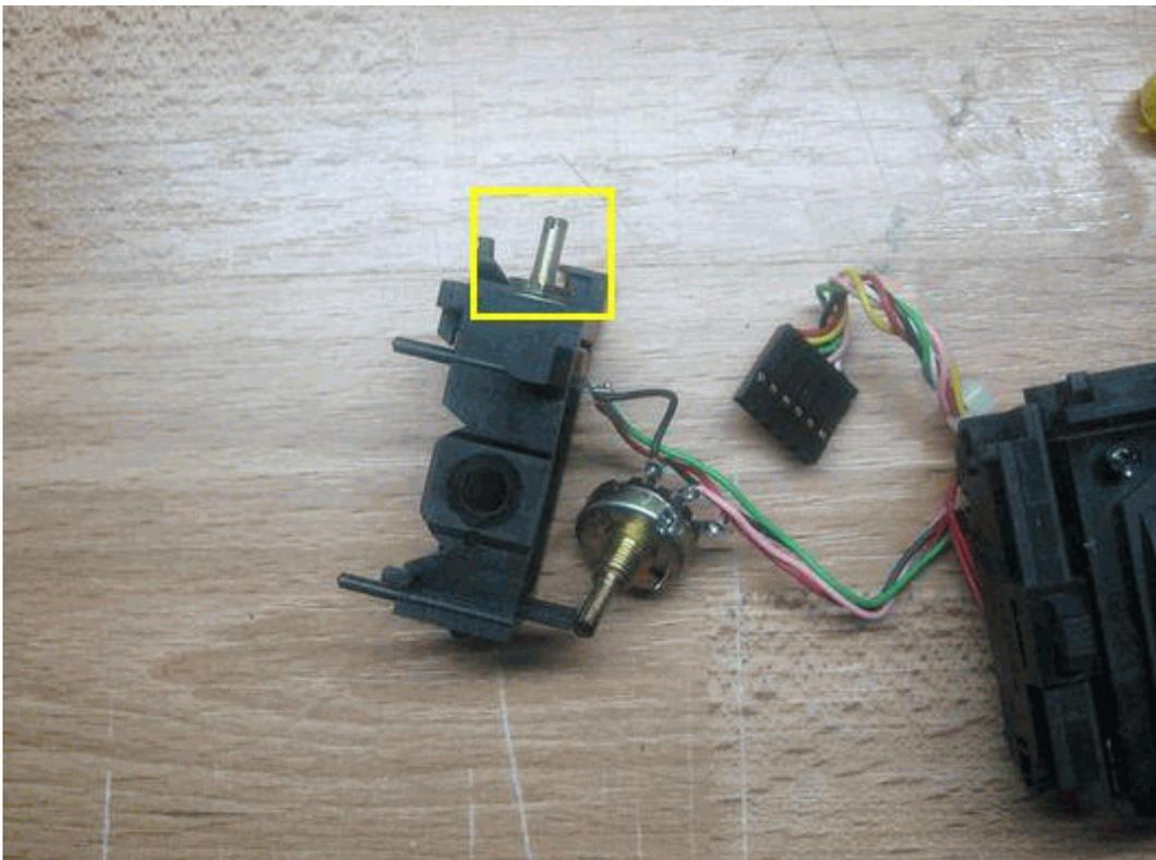
Das zweite Poti wird in gleicher Weise wie das Erste ausgebaut.
