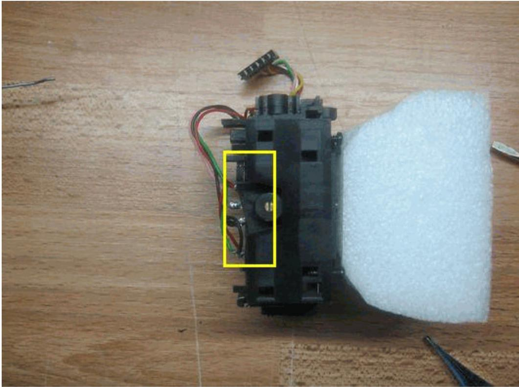
Beim Einbau des zweiten Federbügels und dessen Feder wird es dann leicht schwierig, weil der Haltebolzen nur von oben zugänglich ist. Erfahrungsgemäß dauert dieser Einbau doppelt so lange wie der des anderen Federbügels.
